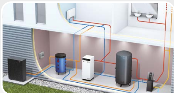
Aptae 18 avec appoint électrique via chaudière électrique E-Tech P pour production double service
