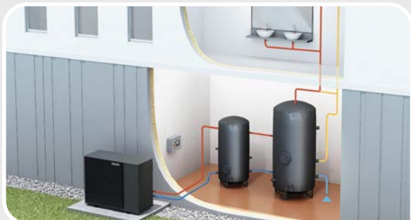
Aptae 23 avec appoint électrique dans le ballon primaire pour production ECS
