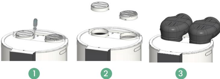
En cas de raccordement avec des gaines, il est nécessaire de paramétrer la régulation en conséquence. Les longueurs de gaine maximales doivent être respectées. Un mauvais gainage (gaines écrasées ou nombre de coudes trop important) peut engendrer une perte de performance et des défaillances machine.
