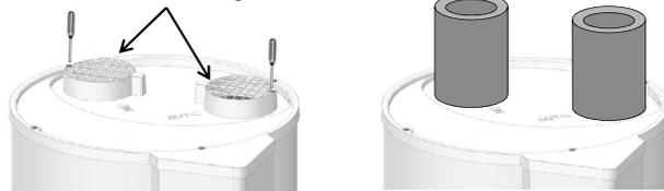
En cas de raccordement avec des gaines, il est nécessaire de paramétrer la régulation en conséquence. La perte de charge totale des conduits et accessoires pour l'évacuation et l'aspiration de l'air ne doit pas dépasser 70 Pa (VM). Les longueurs de gaine maximales doivent être respectées.
