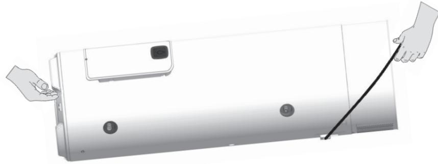
1 Pour déplacer le chauffe-eau : basculez le chauffe-eau vers l'arrière.
