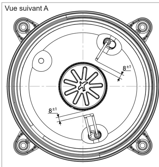
figure 8 - Position électrodes brûleur
