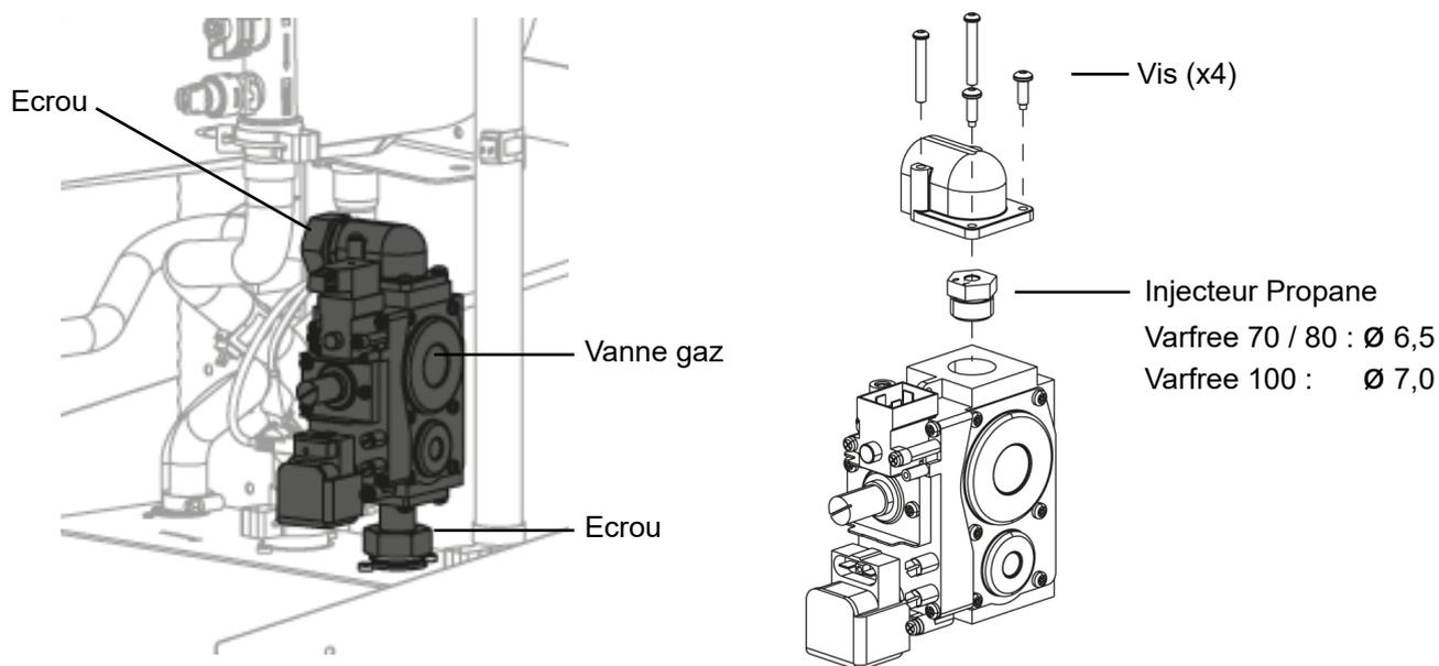
figure 4 - Mise en place injecteur Propane
