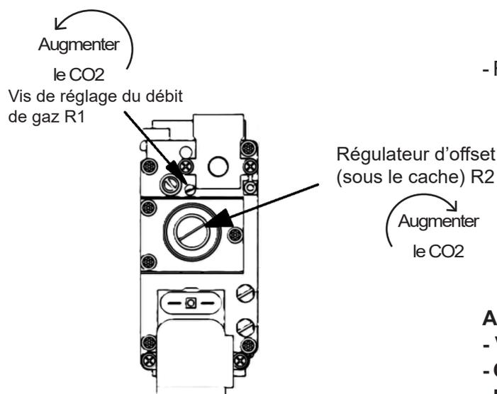
figure 6 - Réglage VARFREE 70 à 100
