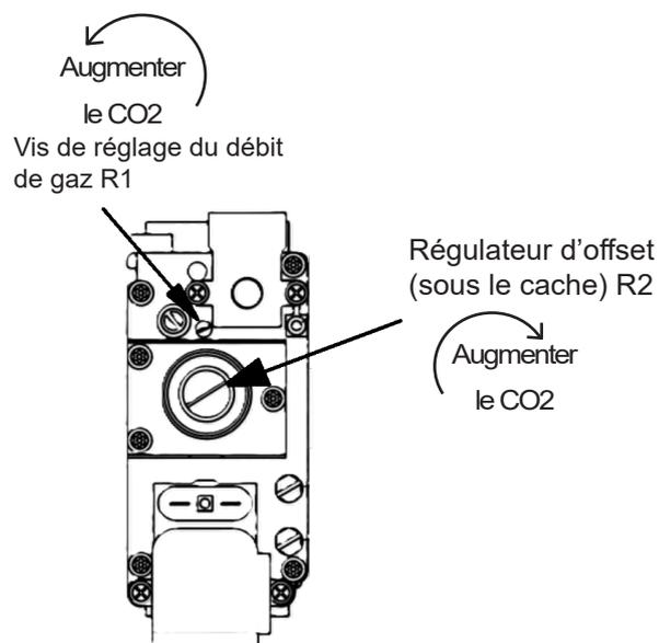
figure 1 - Réglage VARFREE 70 à 120
