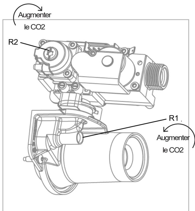
figure 5 - Réglage VARFREE 35 à 60
