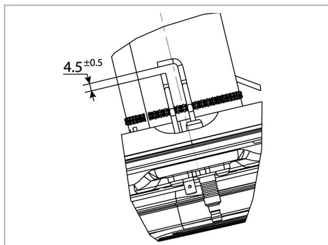
figure 9 - Géométrie électrode
