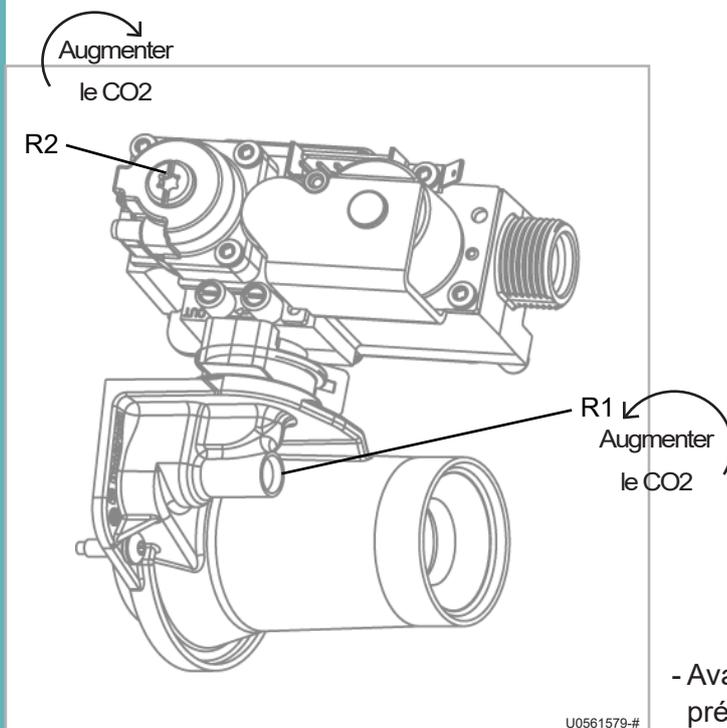
figure 2 - Réglage VARFREE 35 à 60
