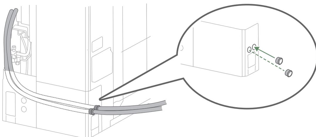
fig. 40 - Passage des câbles et installation des bagues à 1 contact
