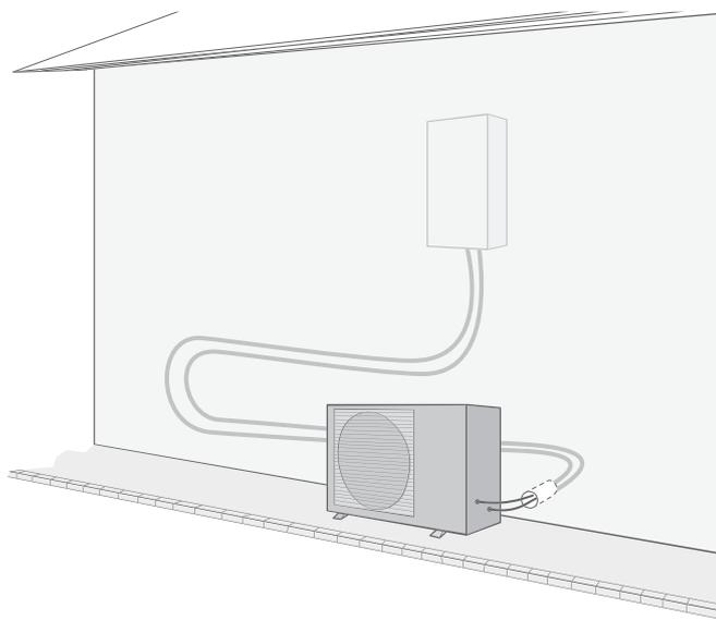
fig. 11 - Exemple conseillé de disposition des liaisons frigorifiques
