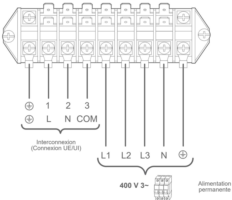
fig. 41 - Borniers de raccordement électrique coté unité extérieure
