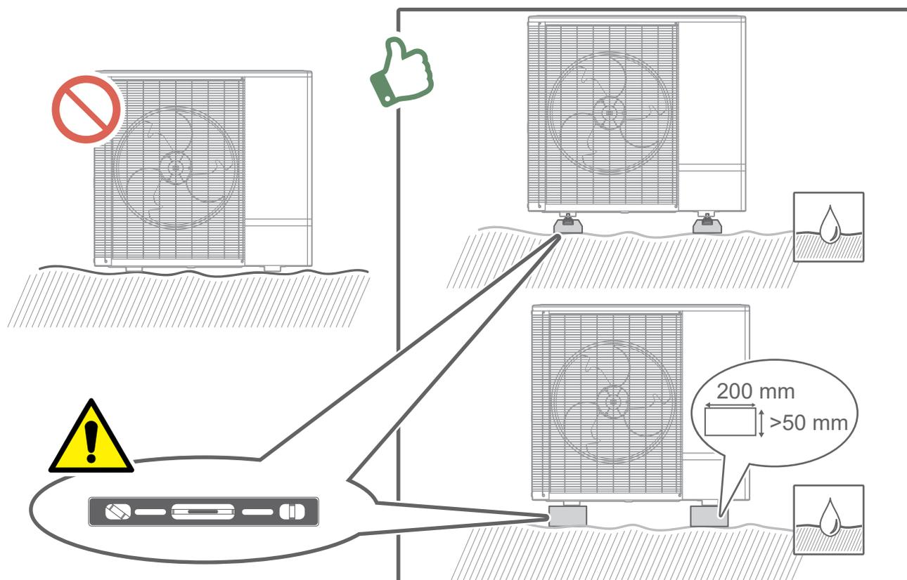
fig. 17 - Pose de l'unité extérieure, évacuation des condensats
