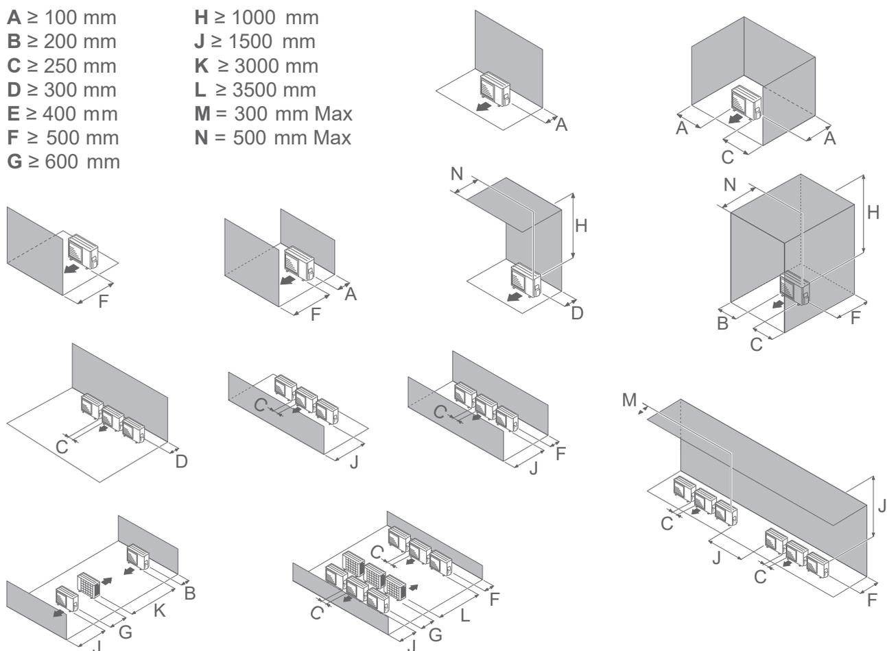
fig. 13 - Dégagements minimum d'installation autour de l'unité extérieure
