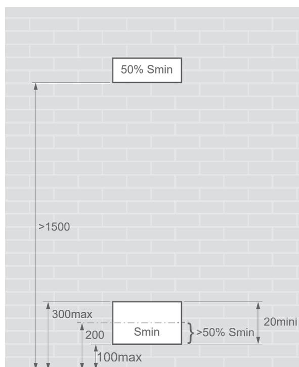
fig. 24 - Position des ouvertures pour la ventilation
