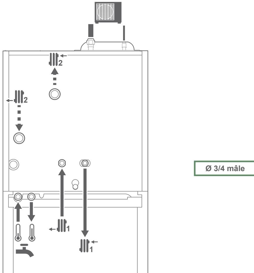
fig. 3 - Raccordements hydrauliques
