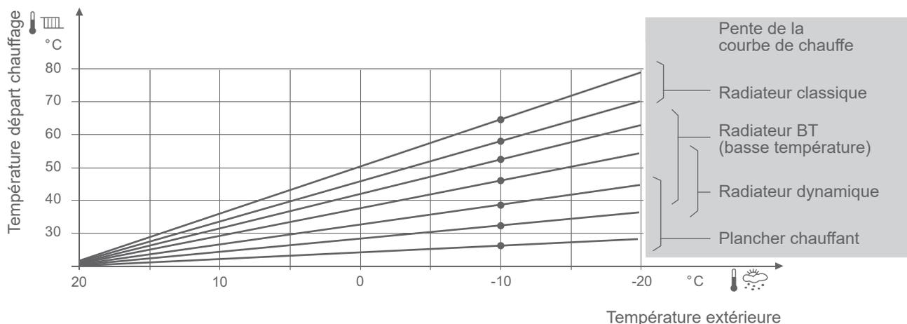
fig. 43 - Pente de la courbe de chauffe
