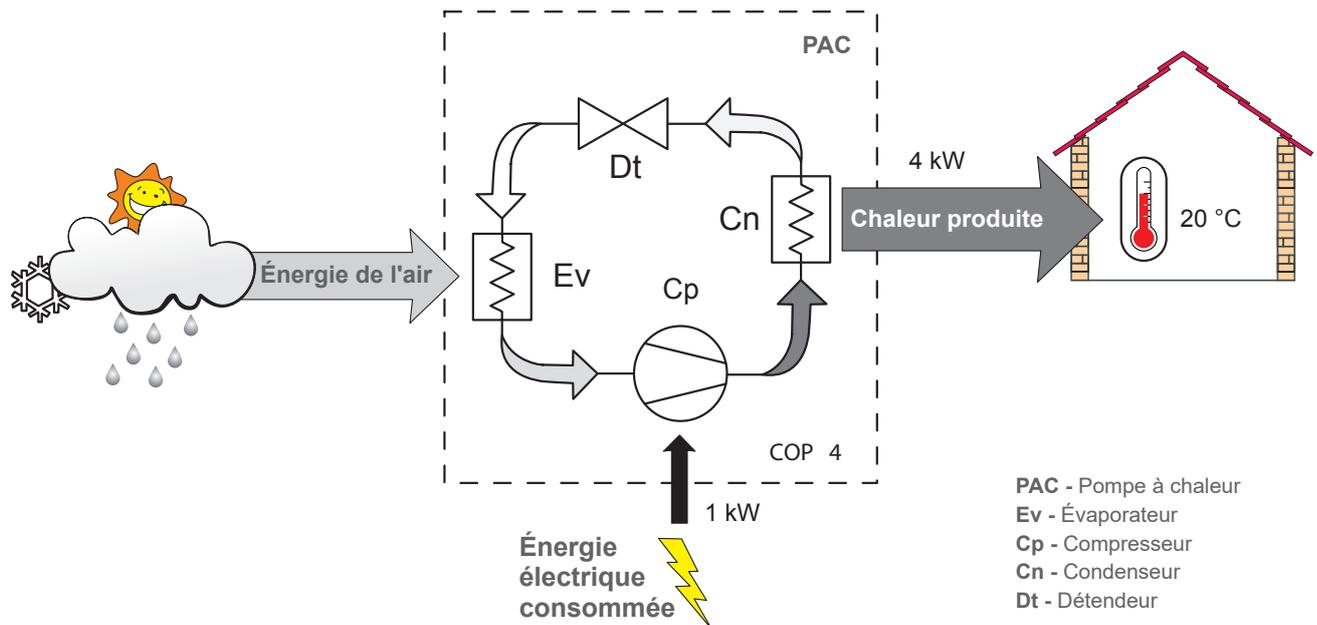
fig. 10 - Principe de fonctionnement d'une pompe à chaleur
