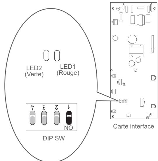
**fig. 36 - Emplacement des interrupteurs DIP et des LED sur la carte d'interface du module hydraulique**
