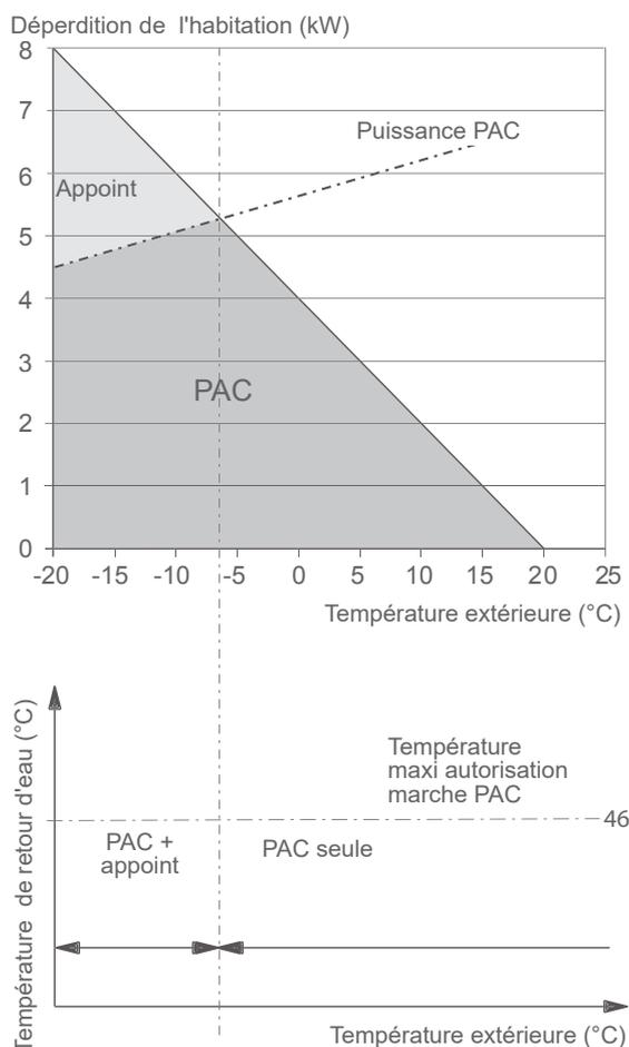
fig. 9 - Exemple et limites de fonctionnement
