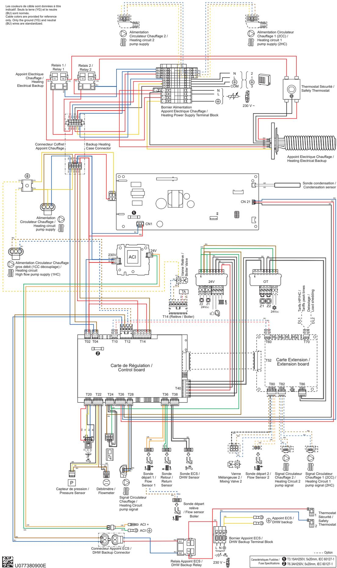
fig. 47 - Câblage électrique du Module Hydraulique - Modèle monophasé
