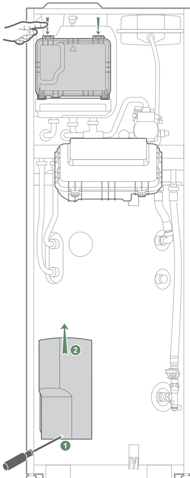
fig. 39 - Accès aux borniers du module hydraulique
