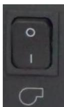
Vérifier que l'interrupteur est bien sur 1 et au besoin tester sa continuité
