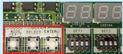
Nota Bene 1: Un appui sur **Enter** permet d'entrer ou de sortir de la lecture du paramètre
