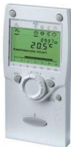
L'utilisation de cette centrale à des fins de correction de la température de chauffage ne doit être fait que si celle-ci est installée dans une pièce représentative de la température du bâtiment et n'est pas perturbée par une source de chaleur ou froid. Voir notice accessoire pour plus d'informations.
