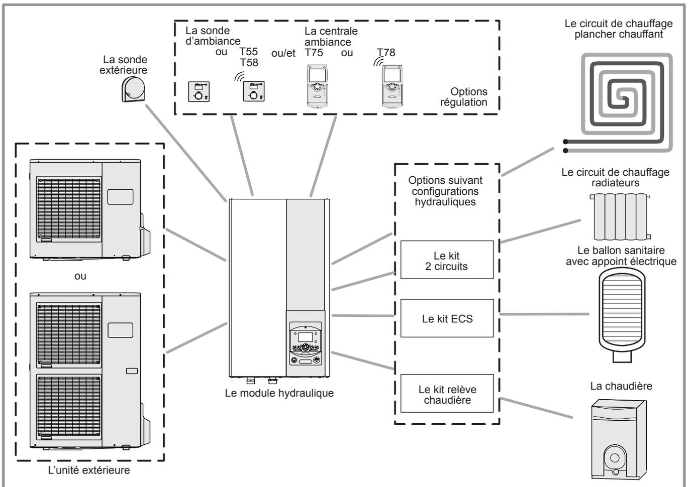
figure 1 - Vue d'ensemble d'une configuration d'installation complète
