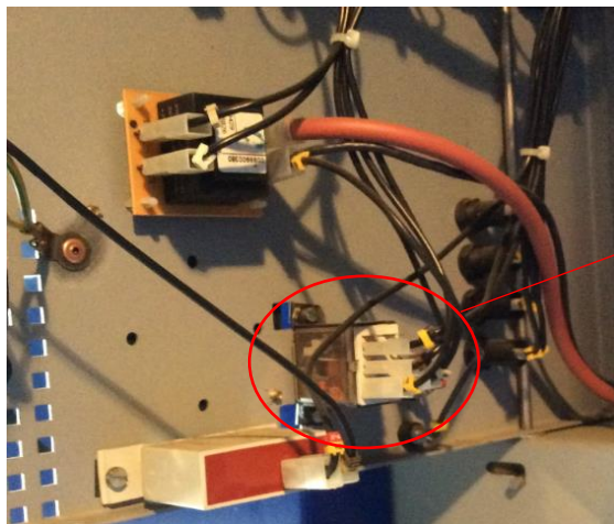
Figure 1 : vérification de la présence d'un contacteur de puissance
