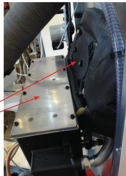
Desserrer les 2 vis de fixation pour déposer l'habillage condenseur.
