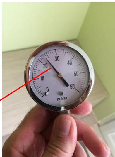
→ pressostat mini GAZ HS, à remplacer
