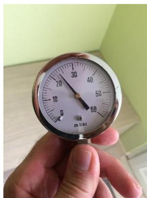
a) S'il y a une chute de pression, l'électrovanne fonctionne.
