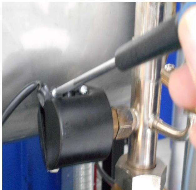
débrancher les fiches et poser un shunt
