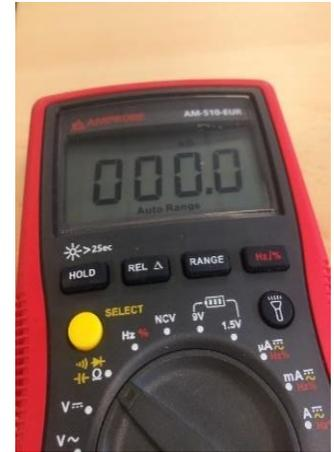
S'il n'y a pas de continuité → remplacer l'électrode d'ionisation
