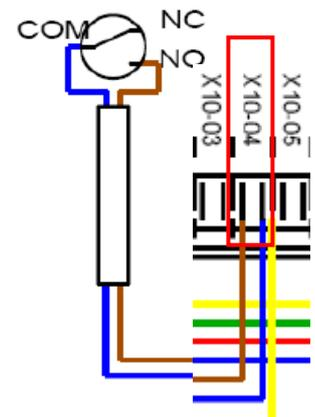
Dévisser le couvercle et débrancher les 2 fils, régler le multimètre sur valeur ohmmètre et tester la continuité. A l'arrêt, il ne doit pas y avoir de continuité entre les bornes NO et COM du pressostat
