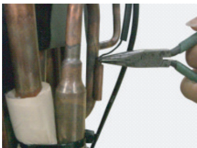
Déposer le ressort de la thermistance.
