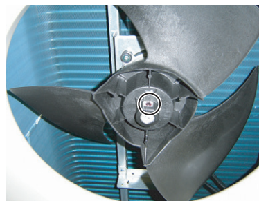
Déposer la vis à tête hex. ( en serrant dans le sens horaire ) et déposer la vis du ventilateur. Pour la repose, noter ce qui suit . Insérer l'hélice et l'arbre moteur à la position de référence D. Et le couple de serrage à la repose. Il doit être compris entre 10 et 15Nm.
