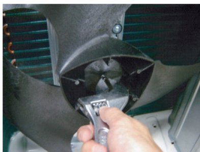
Déposer l'HELICE DU VENTILATEUR.
