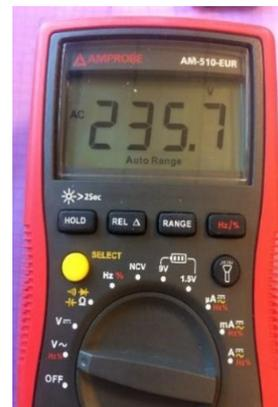
→ **Si tension** : dégommer la pompe si elle ne fonctionne pas, le cas échéant remplacez-la en mettant la chaudière hors tension.
